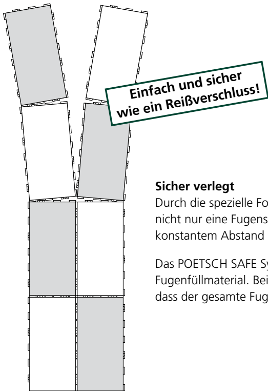
Durch die patentierte POETSCH SAFE Fugensicherung wirkt die Verzahnung wie ein Reißverschluss gegen Verschieben.
